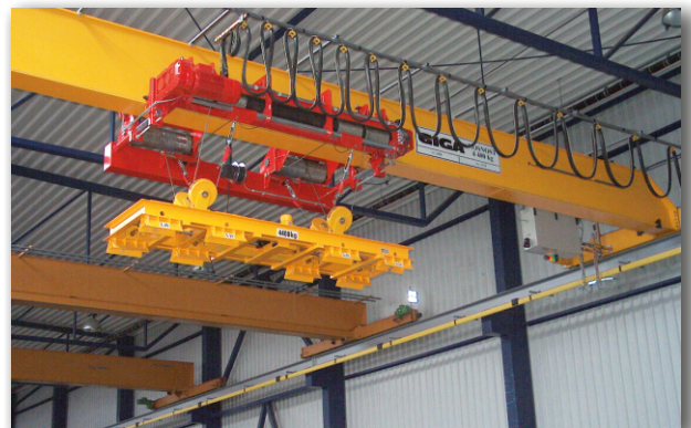
Мостовой кран GIGA тип GJM 4,4t/27,5m с магнитной траверсой с канатной стабилизацией
