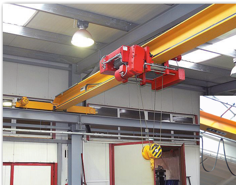
Однобалочный мостовой кран GIGA. Питание тали – энергетической кабельной цепью
