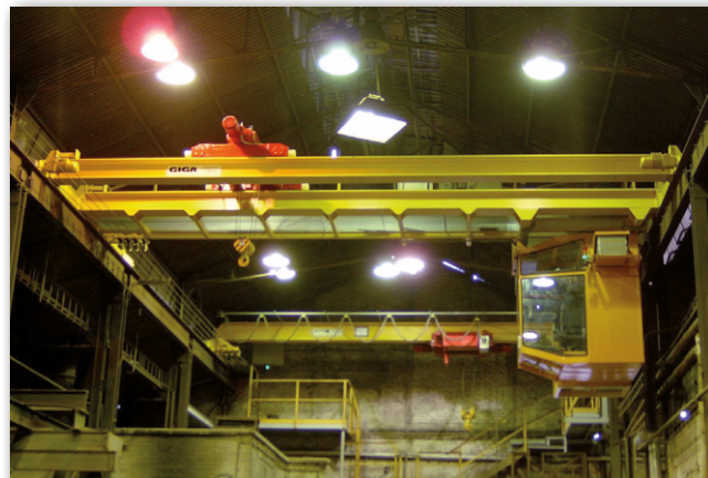
Мостовой кран GIGA тип GDMJ 3,2t/9,43m в сталелитейном исполнении с кабиной
