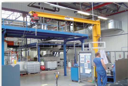
Колонный поворотный кран GSOJ 0,125t/4m
