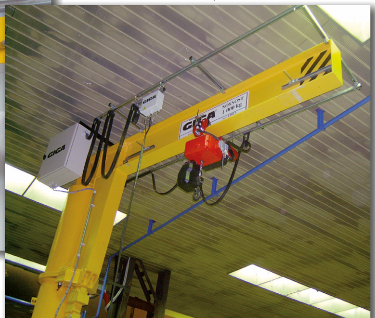
Электрический цепной тельфер CH3 1000.5-JE, установленный на колонном консольном кране GIGA тип GSOJ 1t/3,25m
