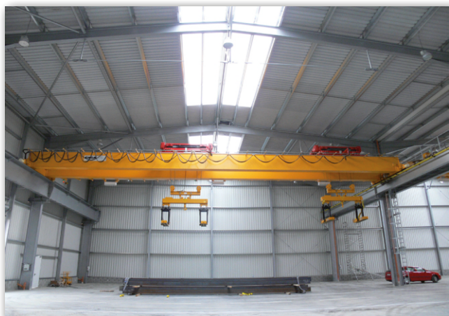
Двухбалочный мостовой кран GDMJ 2x10t/25,5m с двухрельсовой тележкой и канатной стабилизацией магнитной траверсы
