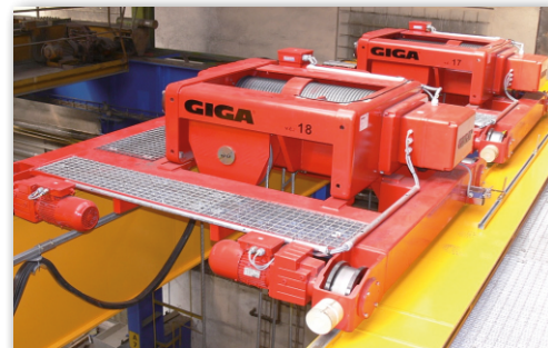
Двухбалочный мостовой кран GDMJ 20t+20t/16,5m
