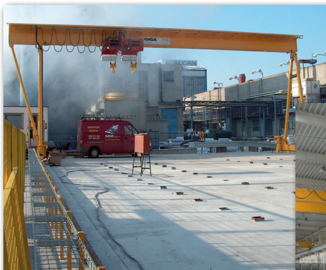
Козловой кран GIGA тип GPMJ 10t+10t/16m Место установки - Alcan Děčín Extrusions, s.r.o., Дечин
