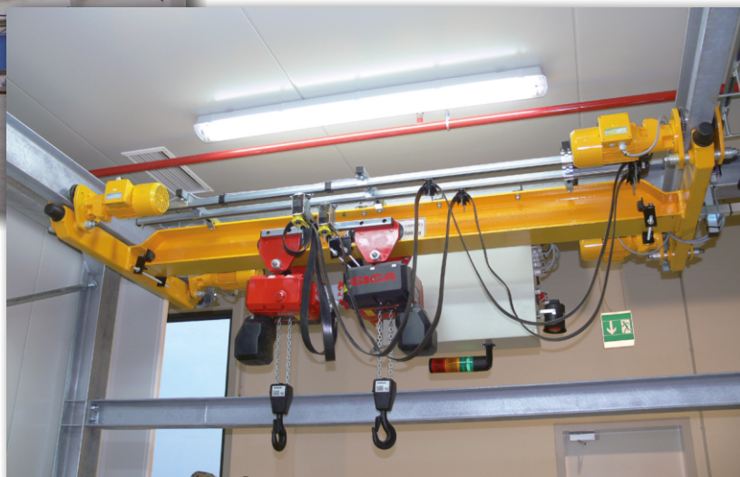
Подвесной мостовой кран GPMJ 2x0,5/4,2м с цепной талью
