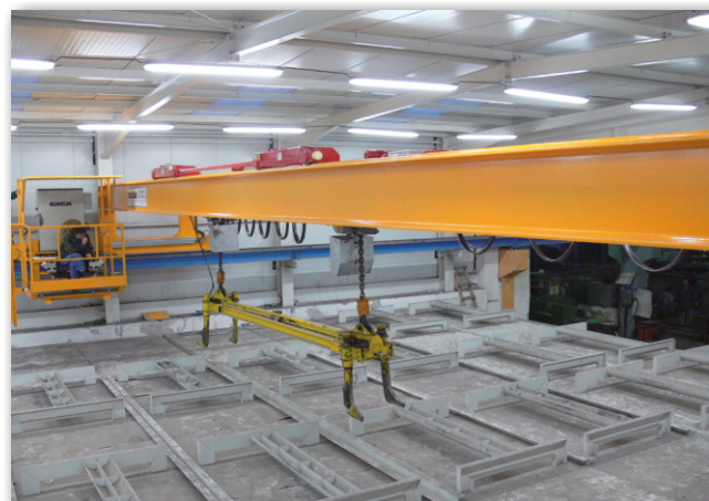
Двухбалочный мостовой кран GIGA тип GDMJ 3,2t+3,2t/14m
