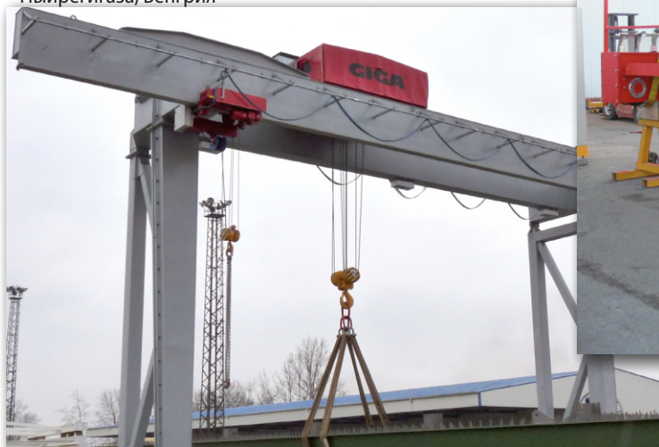
Крановая тележка GWF-120t с грузоподъёмностью 120т, установленная на мостовом кране GDMJ 120t/50t/41,25m Место установки – электростанция Ledvice, Чехия
