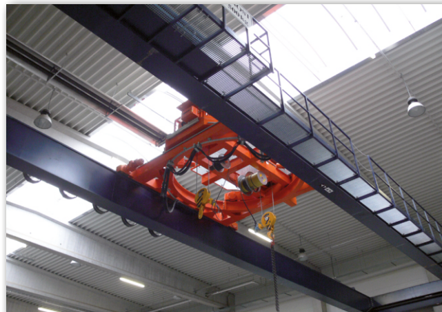
Мостовой кран GIGA тип GDMJ 20t/24,8m с поворотной тележкой
