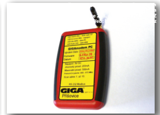
PC модем для беспроводной коммуникации Кран-Компьютер
