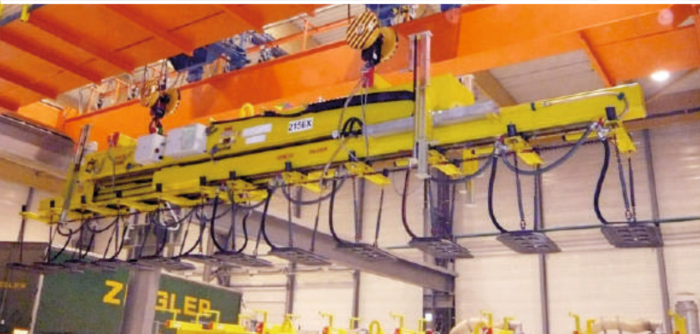
VacuGiant грузоподъемностью 12.000 кг и электрическим приводом изменения длины главной балки от 8 до 12 м.
