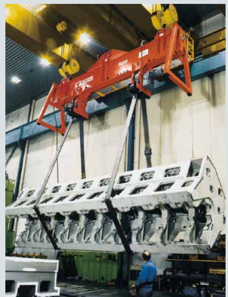
Грузоподъемность: 80 т. Расстояние между ремнями: 1600 - 6000 мм. Регулировка: ручная
