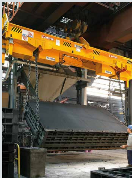
Грузоподъемность: 100 т. Расстояние между цепями: 2900 - 7000 мм. Регулировка: электропривод
