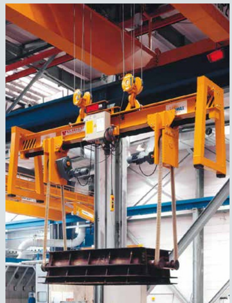
Грузоподъемность: 12 т. Расстояние между ремнями: 1700 - 5000 мм. Регулировка: электропривод
