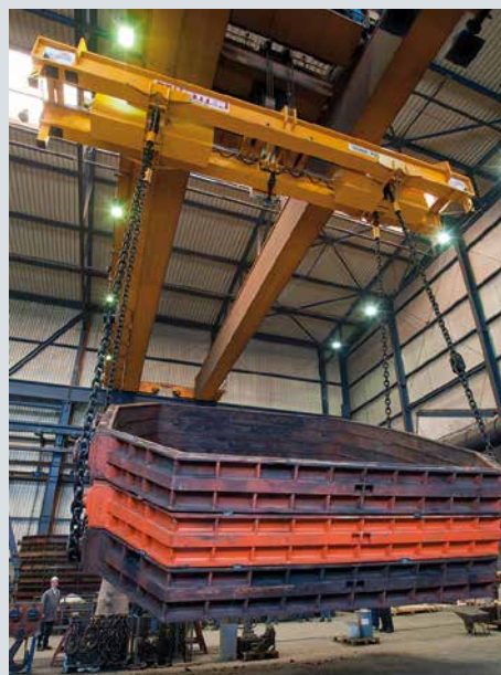
Грузоподъемность: 125 т. Расстояние между цепями: 3050 - 8800 мм. Регулировка: электропривод
