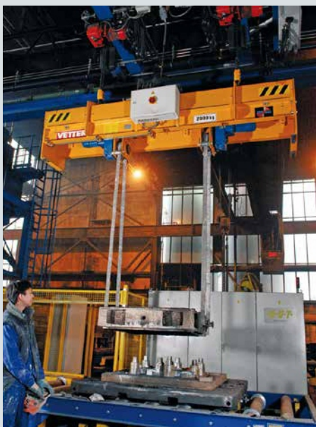
Грузоподъемность: 2 т. Расстояние между ремнями: 900 - 2000 мм. Регулировка: электропривод
